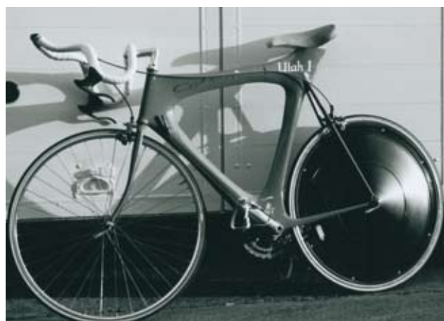
Étude pour un vélo avec cadre en carbone. Profile en aile d'avion, 1989.
